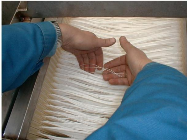
Abbildung 2: Membrane zu einem Modul zusammengefasst
