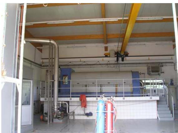
*slika 3: filtrirna tlačna stiskalnica (zgoraj) ter pretočna centrifuga (spodaj)*
