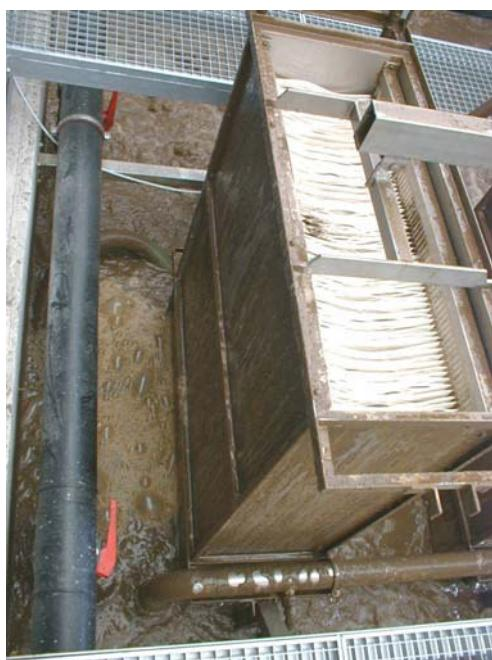
Slika 1: Membranski bioreaktorski sistem
