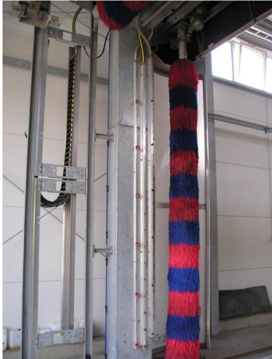
Die Anlage selbst ist mit Dosierpumpen für Reinigungschemikalien ausgestattet, wobei auf verschiedene Wasserqualitäten (Frisch- bzw. Brauchwasser) reagiert werden kann.
