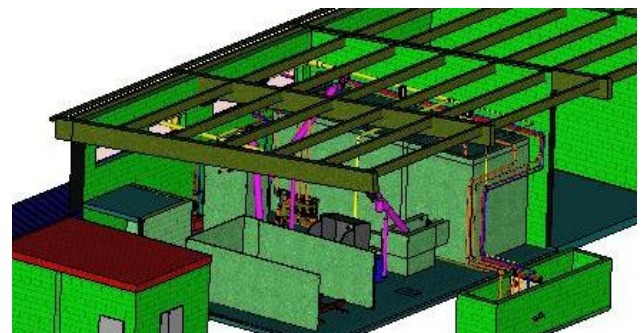
Abbildung 1: 3D-Planung der Co-Substratübernahmestation
